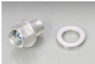
マグドレンボルトは、ネオジム磁石をネジ内部に収納する「セパレート構造」を採用。他社製品のように磁石を露出させないことで、方がの劣化時にもエンジン内部に異物が混入する心配がありません。
